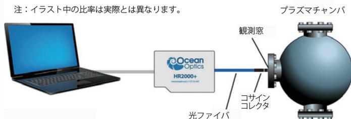
図1：モジュール式分光器によるシステムは、真空チャンバ内のプラズマ測定に適した構成に調整することができます。
