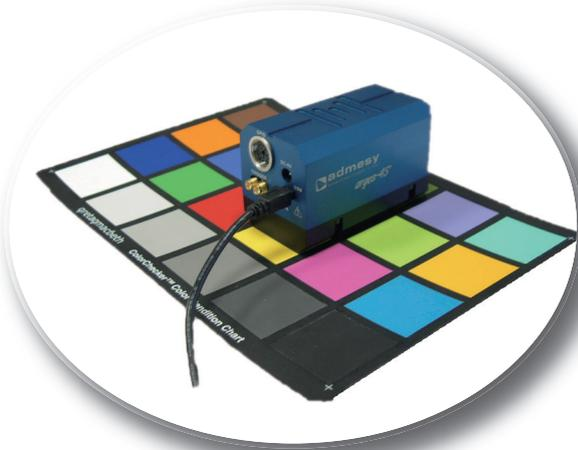
色彩計・反射測定システムの反射板として
