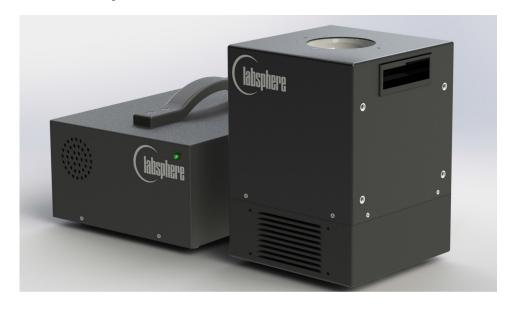
FT-1000/1100-WAF は、カメラの製造分野で要求される画像や色の高度なテストやイメージセンサ校正用に開発されたマルチ LED 均一光源です。ドーム状の積分球出力部は 360°× 200°の 視野角で 94 % 以上の均一性を実現します。積分球内に設置されている複数の可視・近赤外域波長 LED の出力を調整し、CIE 標準イルミナント A・C・D50・D55・D65・D75・E 等の擬似スペクトルとユーザ任意の単色や混合色スペクトルをセンサに照射することができます。
