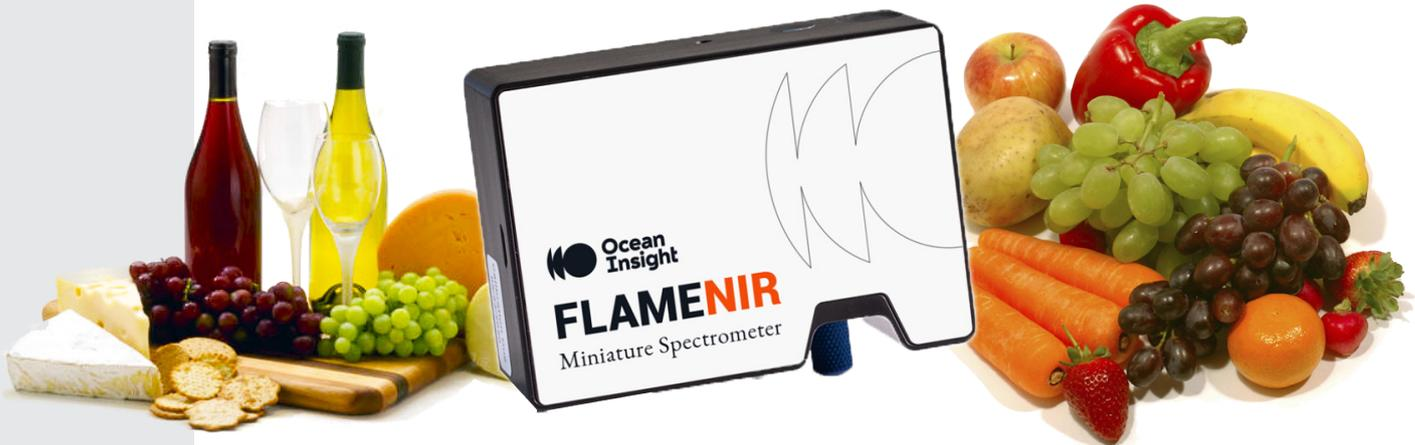
オーシャンインサイト（旧 Ocean Optics（オーシャンオプティクス））社製 Flame-NIR+ は、非冷却 InGaAs デテクタを内蔵した小型・低価格な近赤外用ファイバマルチチャンネル分光器です。
